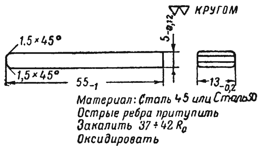
Рис. 165. Оправка для прицельного хомутика
