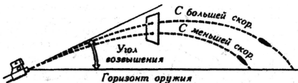
Рис. 38. Зависимость высоты траектории и дальности полета пули от ее начальной скорости.
