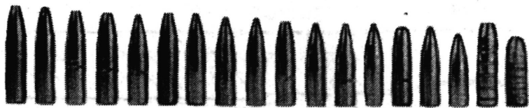
Рис. 63. Различные пули калибра .284 (7,21 мм) существенно отличаются подлине (слева направо): Bitterroot Bonded Core 11,34 г, Nosier Partition 11,34 г, Speer Grand Slam 11,34 г, Speer Grand Slam 10,37 г, Hornady Interlock 9,98 г, Bitterroot Bonded Core 10,37 г, Nosier Partition 10,37 г, Nosier Partition 9,72 г, Nosier Solid Base 9,72 г, Speer Mag-Tip 10,37 г, Nosier Solid Base 9,72 г, Hornady Interlock 9 г, Speer BT 9,4 г, Hornady RN 9,98 г, Speer Spitzer 9,37 г, Speer Spitzer 8,42 г, Cast 10,37 г, RGBS 28-168 FN и Cast 9,07 г.
