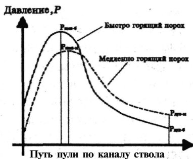
Рис. 11. Кривые изменения давления в канале ствола для быстро горящего и медленно горящего порохов.
