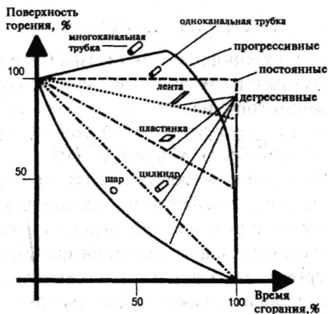
Рис. 9. Горение порохов дегрессивной, постоянной и прогрессивной формы (см. рис. 7).
