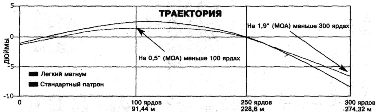
Рис. 6. Сравнение траекторий полета пуль весом 9,72 г калибра 30-06 стандартного патрона и "легкий магнум" компании Hornady: при стрельбе "в ноль" на 250 ярдов (228,6 м) у патрона "легкий магнум" подъем траектории над линией прицеливания почти на 2 дюйма (5 см) меньше.
